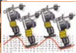
Bewegungsablauf von Vibrationsstampfern.
