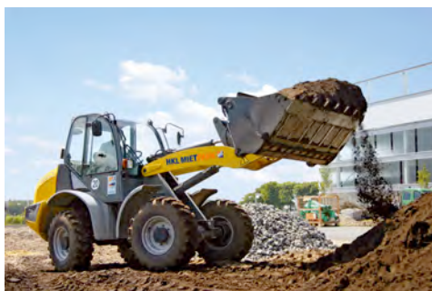
Dank Allradlenkung wendet der Kramer Radlader 750 aus dem HKL MIETPARK auch unter extremen Bedingungen.
