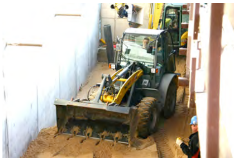
Dank Allradlenkung wendet der Kramer Radlader 750 aus dem HKL MIETPARK auch unter extremen Bedingungen.
