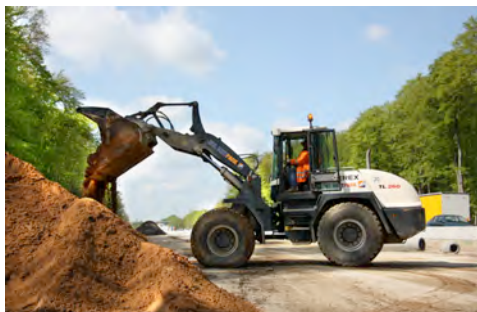
Terex Leistungslader TL 260: 174 PS und 2,7 Kubikmeter fassende Erdschaufel lassen den Lader auch schweres Schüttmaterial kraftvoll und schnell aufnehmen.
