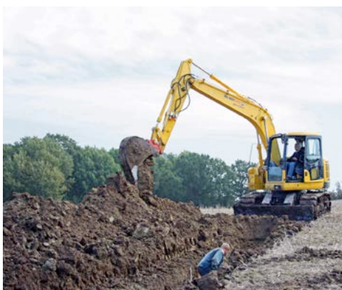
Mit Drainagelöffel arbeitet sich der stabile Komatsu PC 138-US-8 aus dem HKL MIETPARK durch den nassen Feldboden. Dank seines günstigen Gewichtes und der Spezialketten steht er auch auf schwammigen Boden sicher.
