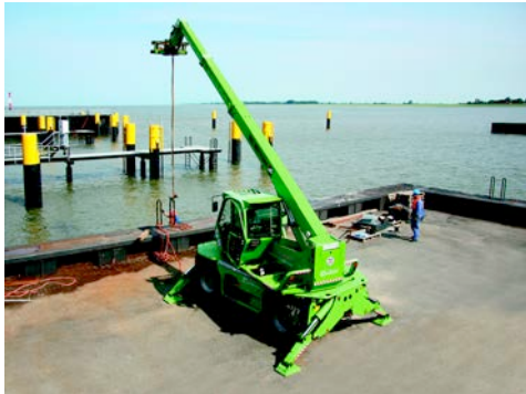
Merlo Roto Teleskopmaschine 38.16 aus dem HKL MIETPARK übernimmt Verladearbeiten beim Bau des neuen Schlepperhafens in Bremerhaven.
