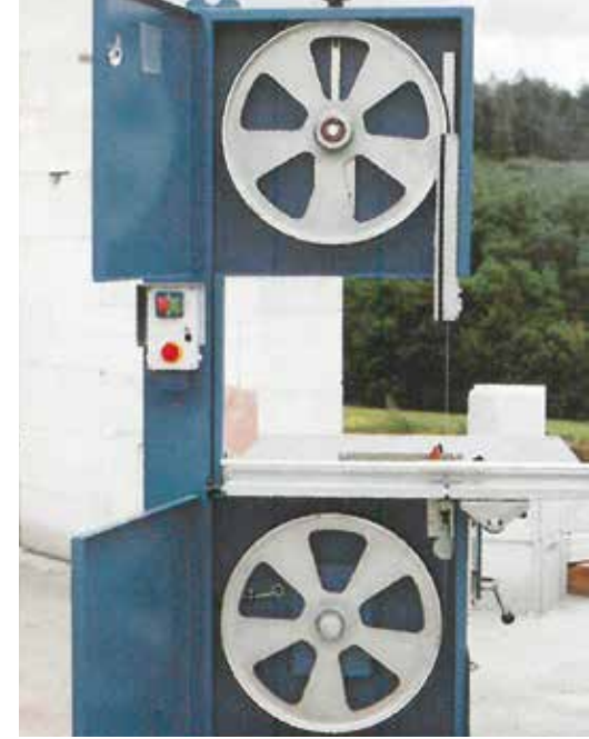
Sägerollendurchmesser 500 mm Saw wheel diameter 500 mm
