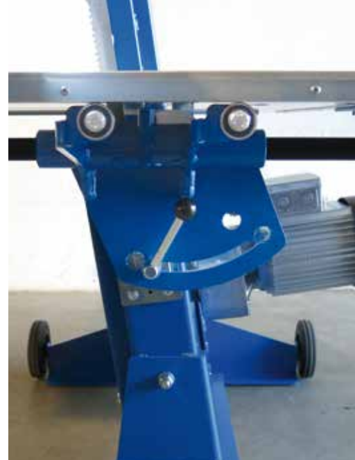
Schrägstellung für Hohlkammerschnitt Slanted position for hollow cell stones
