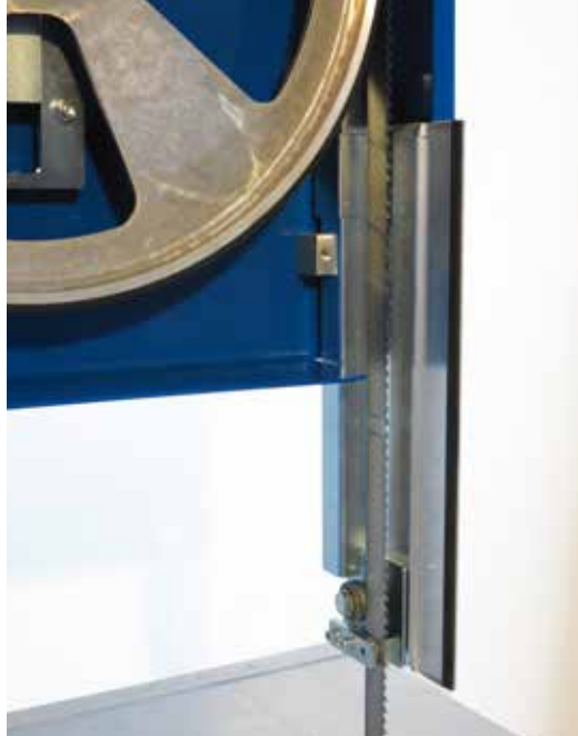
Präzise Sägebandleitung Precise saw blade guidance
