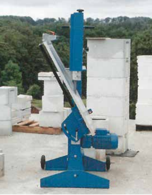
Praktische Transportstellung Practical transport position
