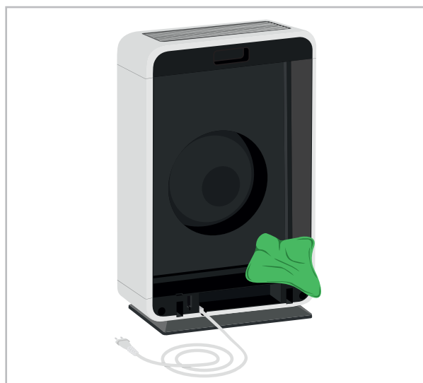
Abb. 17: Reinigung des Filtergehäuses
