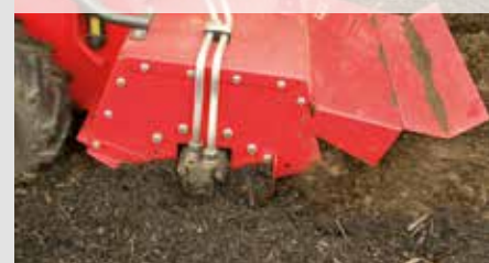
Leicht zugänglicher Ölmotor am Fräskasten
