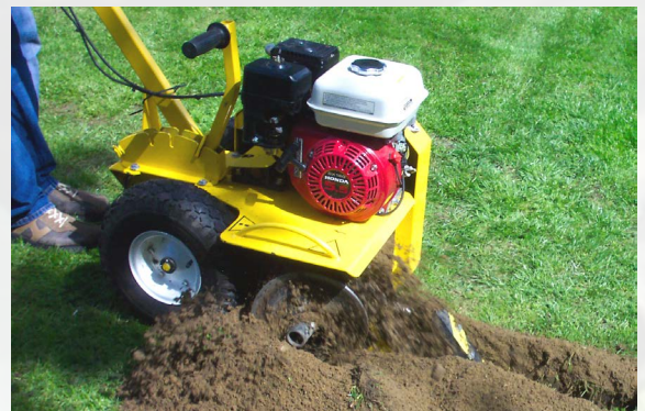
Seitlicher Erdbodenauswurf durch Förderschnecke.
