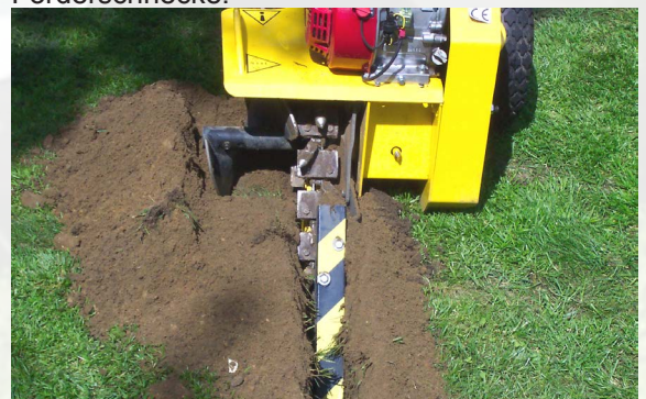
Die Fräsengeschwindigkeit beträgt ca. ein bis zwei Meter pro Minute.
