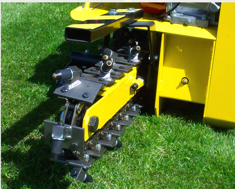
Seitlicher Erdbodenauswurf durch Förderschnecke.
