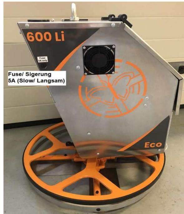
Bild 4: Sicherung positionieren
