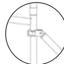
13. Falls erforderlich (siehe Ballastierungstabelle unter IX), befestigen Sie mit Hilfe der Ballasthalter die Ballastgewichte auf den 4 Vertikalrohren des Basisrahmens.
