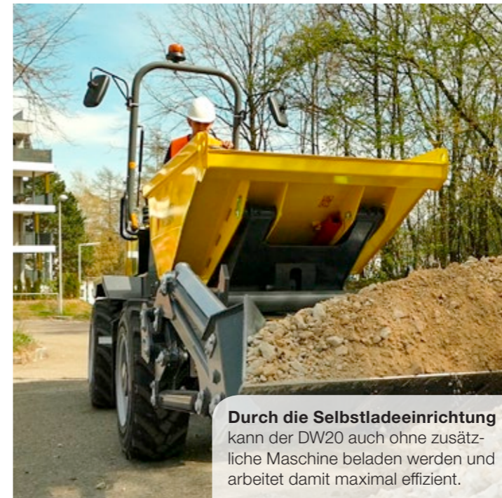
Seitliches Ausladen auf den Punkt: mit Drehkipplmulde und stufenlosem 180°-Abkippen kein Problem.
