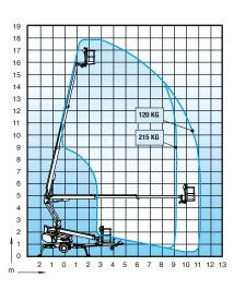
Max. Arbeitshöhe 18,00 m Max. Plattformhöhe 16,00 m Max. seitliche Reichweite 11,20 m Abstützbreite 3,9/4,3 m Korblast 215 kg Plattformgröße 0,7x1,3 m Drehbereich endlos Korbschwenkung 180° Steuerung proport. Transportlänge 6,70 m Transportbreite 1,95 m Transporthöhe 2,29 m Gewicht 2300 kg Fahrantrieb standard Steckdosen standard im Arbeitskorb x 2 Elektromotor standard Benzinmotor optional Dieselmotor optional Steigfähigkeit 25%
