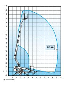
Max. Arbeitshöhe 16,00 m Max. Plattformhöhe 14,00 m Max. seitliche Reichweite 9,10 m Abstützbreite 3,8/4,2 m Korblast 215 kg Plattformgröße 0,7x1,3 m Drehbereich endlos 180° Korbschwenkung Steuerung proport. Transportlänge 6,15 m Transportbreite 1,80 m Transporthöhe 2.29 m Gewicht 1960 kg **Fahrantrieb** standard Steckdosen standard im Arbeitskorb x 2 Elektromotor standard Benzinmotor optional Dieselmotor optional Steigfähigkeit 25% des Fahrantriebs
