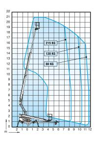
Max. Arbeitshöhe 21,00 m Max. Plattformhöhe 19,00 m Max. seitliche Reichweite 11,70 m Abstützbreite 3,9/4,3 m Korblast 215 kg Plattformgröße 0,7x1,3 m Drehbereich endlos 180° Korbschwenkung Steuerung proport. Transportlänge 7,95 m Transportbreite 1,93 m Transporthöhe 2,29 m Gewicht 2465 kg Fahrantrieb standard Steckdosen standard im Arbeitskorb x 2 Elektromotor standard Benzinmotor standard Dieselmotor optional Steigfähigkeit 25% des Fahrantriebs
