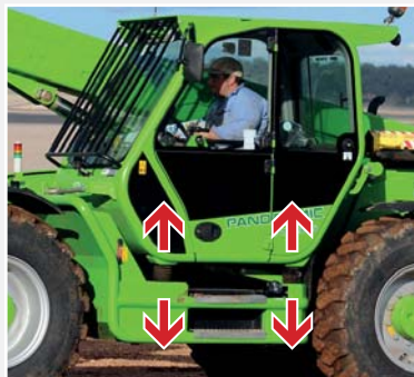
Vom Bediener aktivierbare hydropneumatische Schwingungsdämpfung der Kabine Die einzige am Markt erhältliche ihrer Art.
