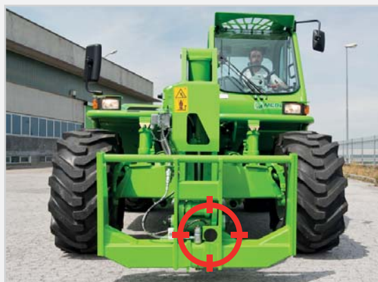
Am Anbaurahmen angebrachter Sensor
