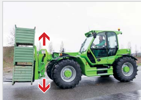
BSS hydropneumatische Armaufhängung vom Bediener zuschaltbar, beschleunigt sie die Transporte, schützt die Ladung und verbessert die Produktivität. Sie schaltet sich ab bei einer Geschwindigkeit unter 3 km/h.
