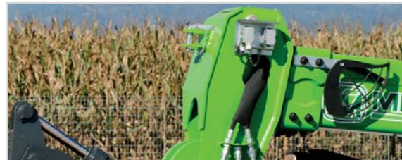
Rohre, Elektrokabel und zusätzliche Hydraulikleitungen befinden sich im Inneren des Teleskoparms, wo sie gut geschützt sind.
