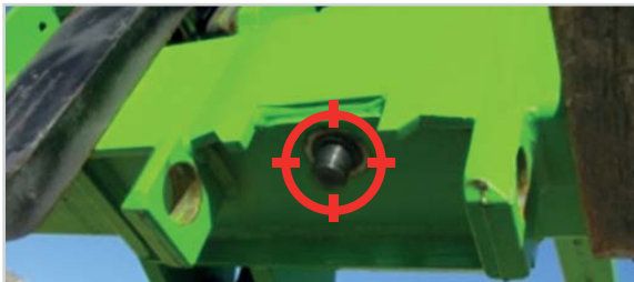
Tac-Lock: hydraulische Befestigung der Anbaugeräte direkt von der Kabine aus
