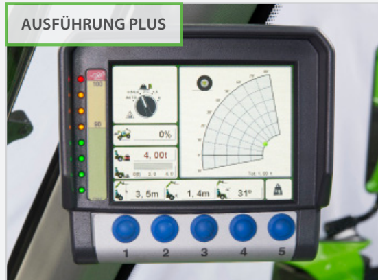
M CDC System mit Display und automatischer Erkennung des Anbaugeräts
