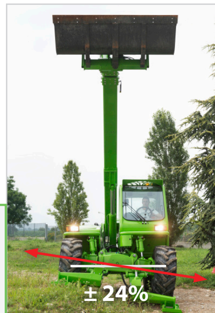
Kombinierte Wirkung von seitlicher Neigung und Abstützungen
