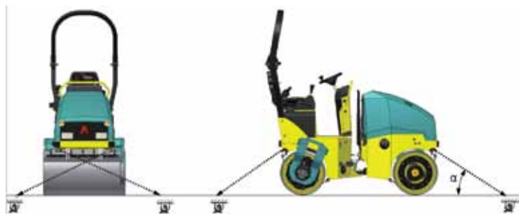
4 große Befestigungsösen für eine sichere Fixierung auf einem Anhänger / LKW
