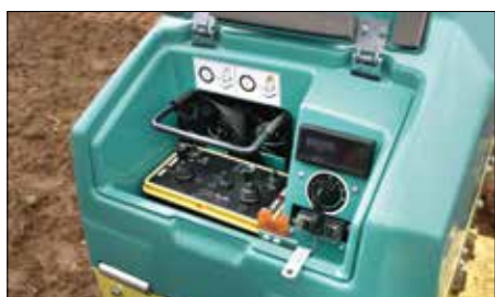
Abschließbares Cockpit mit übersichtlichen Bedienelementen
