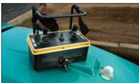
Infrarot-Fernsteuerung mit Solarzellen – Kein Ladegerät notwendig. Lädt permanent während dem Arbeiten
