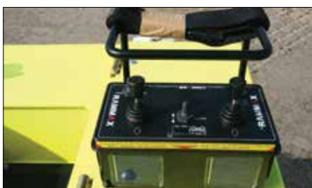
Infrarot-Handsender mit Solarzellen
