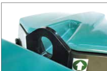
Zentrale Verladeöse für problemloses und schnelles Versetzen. Große Zurrösen zur Befestigung beim Transport.
