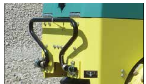
Optionaler Abschaltbügel mit einfacher Transportarretierung.
