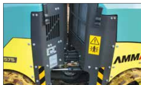
Wartungsfreies Knick-Pendelgelenk für optimalen Kontakt zum Untergrund
