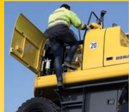
Handläufe und rutschfeste Oberflächen
