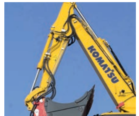
Neue HCU-Verrohrung mit einheitlicher Ausführung für alle Stiellängen
