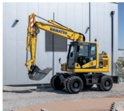
Laststabilisator für Ausleger (ECSS) für mehr Fahrerkomfort
