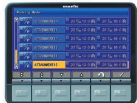
Komatsu Integrierte Anbaugerätesteuerung (KIAC)
