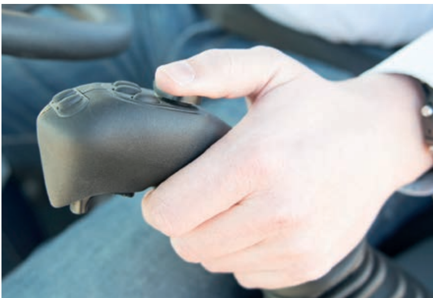
Das optional verfügbare und anpassbare Joystick-Lenksystem ermöglicht leichtgängiges Lenken der Maschine ohne großen Kraftaufwand
