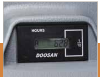
Betriebsstundenzähler (vom Boden aus ablesbar)
