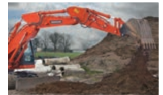
Zweiteiliger Ausleger Der zweiteilige Ausleger bietet eine maximale Grabreichweite von 8720 mm.
