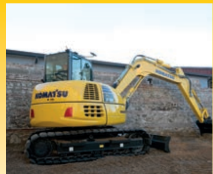
Kinderleichtes Grabenziehen dank reduziertem Frontschwenkradius und Auslegerschwenkfunktion
