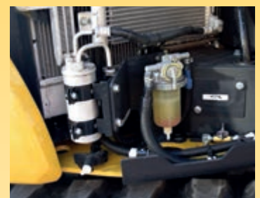
Der große Kraftstofffilter und der Kraftstoffvorfilter mit Wasserabscheider schützen den Motor.
