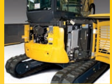
Hintere Wartungskappen für schnelle Motorinspektion und Betankung, einfachen Wartungszugang, leichte Reinigung der Kühler und guten Zugang zur Batterie
