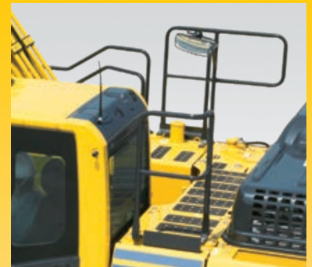
Handläufe und rutschfeste Oberflächen
