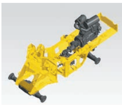
Robuster, verwindungssteifer Rahmen
