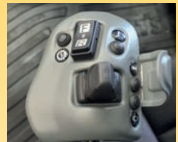
Komatsu Kurzhebel-Lenksystem (K-SLS) (optional)
