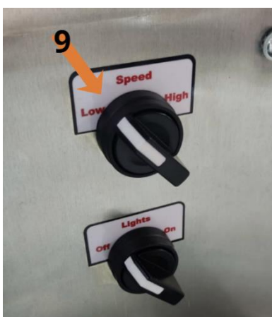
Abbildung 6: Low / High speed Schalter
