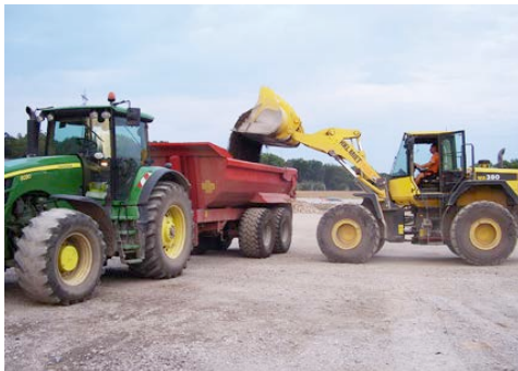
HKL Radlader beim Verladen von Recycling-Material beim Ausbau der A 5.
