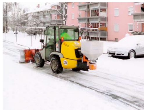
HKL Radlader mit Schneeschild und Streuer sorgt für sichere Straßen im bayerischen Kaufbeuren.
